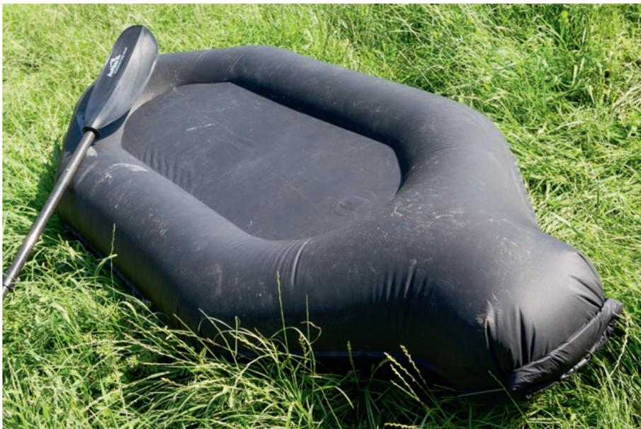
**Retterungsring:** Die Luftkammer umschließt den Boden, der selbst nicht mit Luft befüllt ist.
