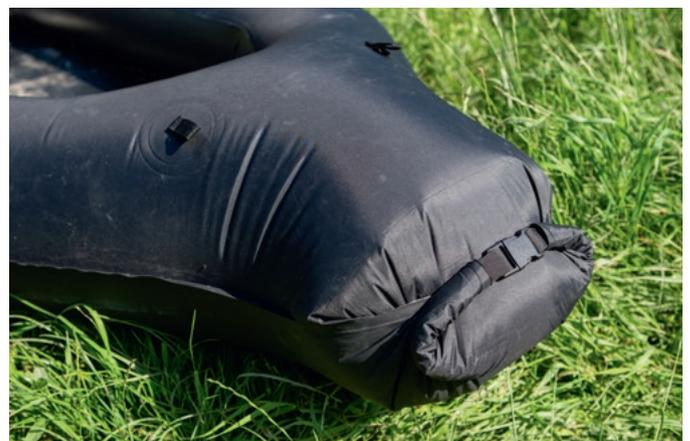
**Variabel:** Der Rollverschluss macht die Luftkammer zum Gepäckraum und verlängert das Packraft für besseren Geradeauslauf.
