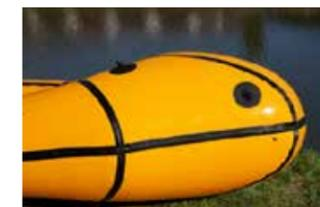
**Kleber kommt nicht zum Einsatz:** Die Nähte des Anfibio-Packrafts sind doppelt verschweißte.
