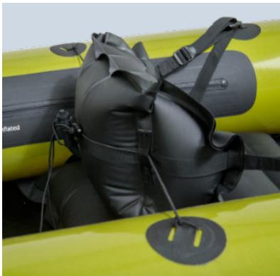
Die Lehne ist passend zum Sitz bzw. ihrer Körpergröße einzustellen, dazu montieren Sie die Rückenlehne über die Zugriemen und Gummizüge wie abgebildet. Die Lehne sollte sich auf der hinteren Kammer des Sitzes abstützen.
