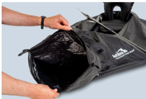
Beim Schließen des Rollverschlusses ist darauf zu achten, dass er möglichst faltenfrei gewickelt wird, um die Dichtheit zu gewährleisten!
