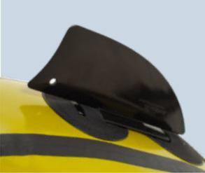
Standardmäßig ist eine Finnenhalterung angebracht, bestehend aus zwei Einschubblasen am Heck des Bootes, (außer Anfibio Nano SL/RTC). Die optional erhältliche Finne kann leicht montiert oder demontiert werden.
