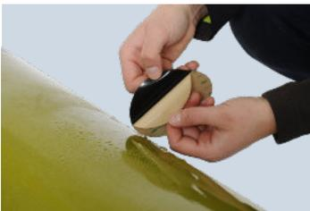
Anfibio Packrafts sind einfach zu reparieren. Grundlegende Reparaturarten werden nachfolgend erklärt. Grundsätzlich müssen alle Reparaturstellen sauber, trocken und fettfrei sein. Es wird empfohlen, die Stellen unmittelbar vor der Reparatur großzügig mit Alkohol/Spiritus zu reinigen und abtrocknen zu lassen.
