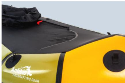
Die Spritzdecke des Anfibio Rebel 2K besteht aus einer Klett- und Reißverschlusskonstruktion. Zum Schließen des Verdecks wird erst der Reißverschluss und dann der Klettverschluss geschlossen. Die Spritzdecke ist so konzipiert, dass sie sich bei einer Kenterung öffnet und der Paddler aus dem Boot fällt.
